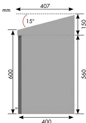
Ergonomie : Pans coupés renforçant la rigidité des parois latérales (modèle déposé)
