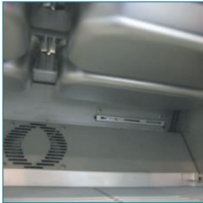
Ventilateur en partie arrière pour une meilleure température des bacs GN
