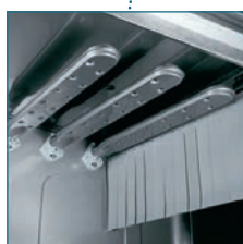
Bras de lavage en inox avec 12 buses. Aucune déperdition
