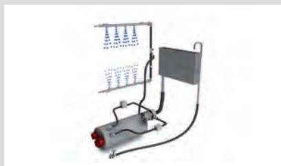
Dispositif de rinçage totalement indépendant de la pression du réseau, composé d'un surchauffeur à pression atmosphérique (réservoir annexe) et d'une pompe (surpresseur), garantissant une température de rinçage et un débit constants.
