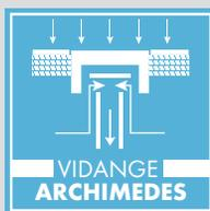
Durant le rinçage une partie de l'eau de la cuve est pompée. Ce système de vidange évacue en priorité l'eau sale dans le fond de la cuve, permettant une économie d'eau et de produits lessiviels.
