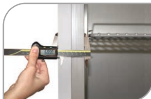
Épaisseur d'isolation : 60 mm
