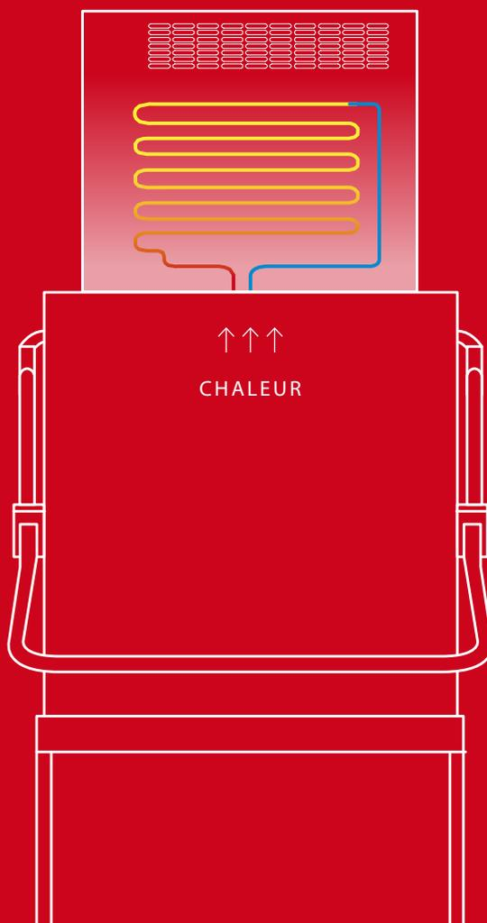
Ce dispositif récupère les calories et condense les buées pour créer un environnement de travail plus confortable. La diminution de l'humidité contribue également à accélérer le séchage de la vaisselle.
